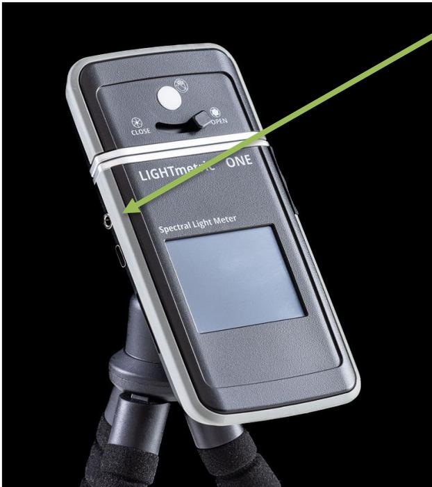
LIGHTMETRIC ONE 可以使用标准的闪光灯同步线与相机连接。设备会自动识别 3.5 毫米插头是否已插入相应的插口。
