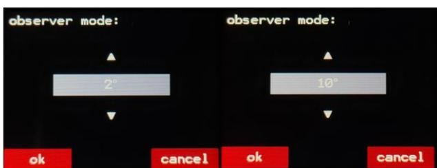
可在此菜单中选择用于计算  $2^\circ$  或  $10^\circ$  颜色坐标的观察角度。
