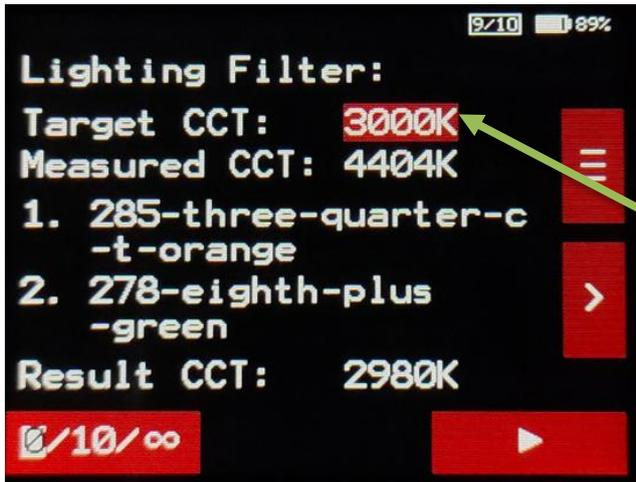
在该显示屏中，可以定义照明滤光片，通过这些滤光片可以调整当前照明，从而达到所需的色温。最多可计算两个滤光片的组合。附录中列出了可能的滤光器。
