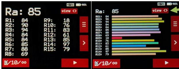
Durch Druck auf „view <>“ kann in einigen Displays die Darstellungsweise der Messergebnisse umgeschaltet werden. So ist es beispielsweise möglich, im Display CRI die Farbwiedergabewerte als Balkendiagramm mit kleinen Zahlenwerten, oder als größere Zahlenwerte ohne Balkendiagramm darzustellen.
