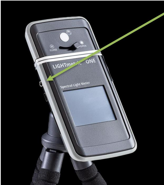
Das LIGHTmetric ONE kann mittels handelsüblichen Blitz-Synchronkabel an eine Kamera angeschlossen werden. Das Gerät erkennt selbständig ob der 3.5 mm Klinkestecker in der entsprechenden Buchse eingesteckt wurde.
