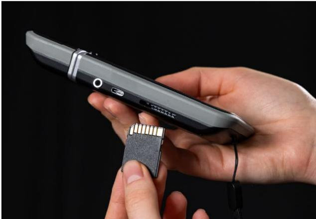
Dieses Menü ist nur aktiv wenn eine SD-Karte im SD-Karten-Slot eingesteckt ist. Durch Druck auf den Menüeintrag „data > SD card“ werden alle Daten aus dem internen Speicher auf die SD-Karte übertragen.
