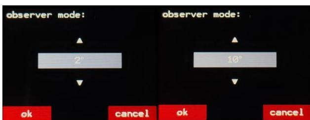
En este menú se puede seleccionar el ángulo de observación para calcular las coordenadas de color de 2° o 10°.
